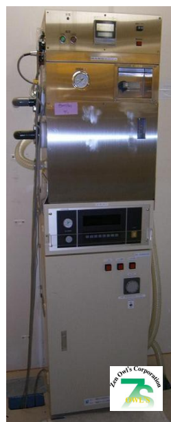
純水昇圧ユニット
